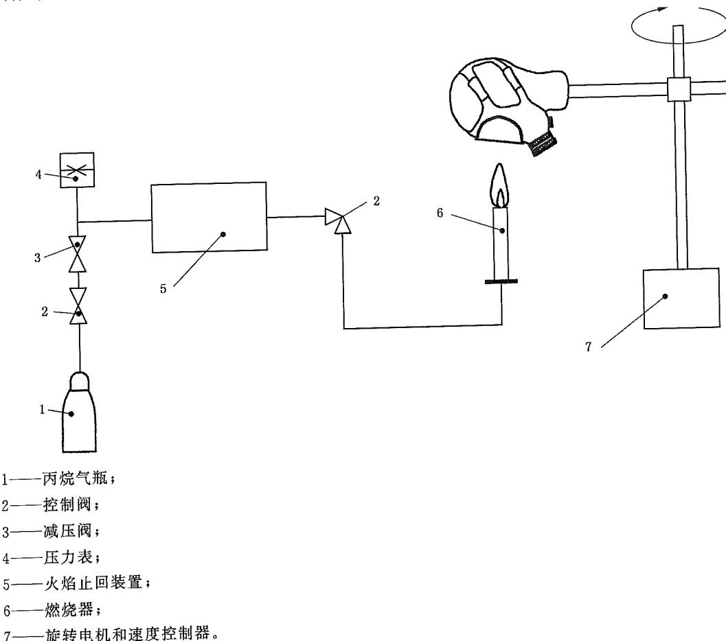
图 6 可燃性检测装置示意图
