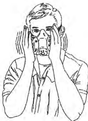
图 G.1 负压气密性检查
